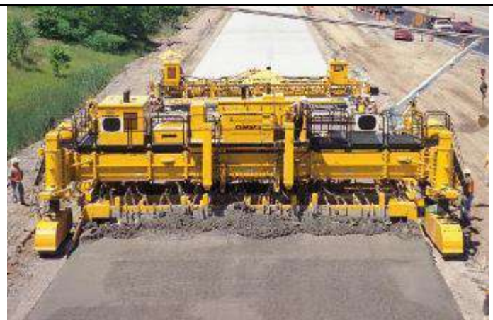
Imagen ilustrativa: Extendidora de encofrado deslizante - GP-4000. El equipo hace la colocación de barras, regula el espesor definido, el terminado final es el único proceso manual.
